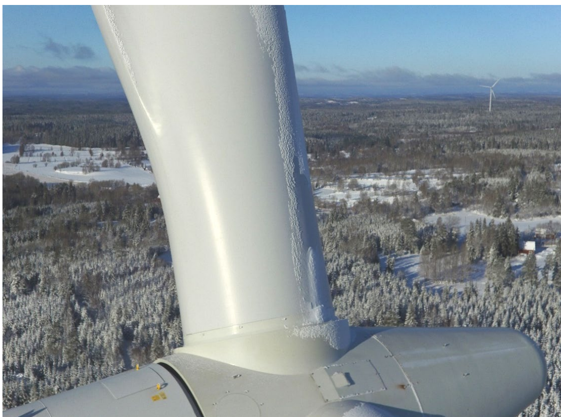
Figur 27. Exempel på ispåbyggnad på vindkraftverk i Fredriksdal vindkraftspark i Nässjö kommun. Foto av Jonathan Hjorth.
